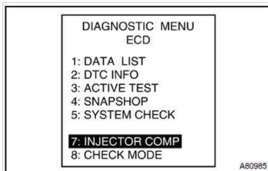
3. Seleccionar el cilindro donde se puso el inyector y digitar el código
